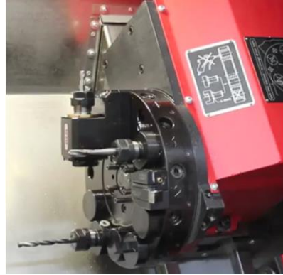
شكل رقم ٣٣: قلم القطع بعد تركيبه ببرج العدة
